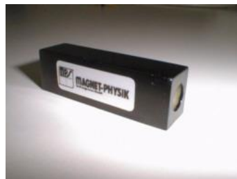
Abb. 2: Magnetische Abschirmkammer NK 1
