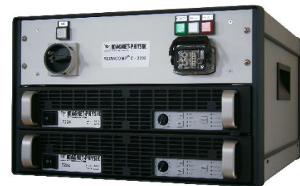
Geräteschrank des REMACOMP® C - 2200 mit beiden Leistungsverstärkern
