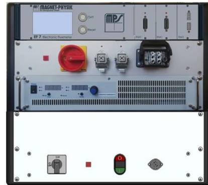
Geräteschrank der PERMAGRAPH® - REMAGRAPH® - Kombination C - 850 (mit optionaler Temperaturregelung TM 1 zur Messung von Permanentmagneten bei Temperaturen von 200 °C)
