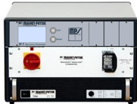
REMAGRAPH®-REMACOMP®-Kombination C - 1207 mit elektronischem Fluxmeter EF 7. (Der separate PC ist nicht abgebildet.)
