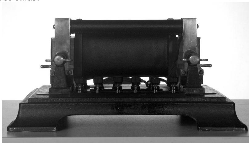
Wenn Sie ein **Fahy-Simplex-Permeameter** besitzen und dieses weiterbenutzen möchten, können Sie es an einen REMAGRAPH® C - 600 anschließen. Den notwendigen Kabelsatz können wir liefern. Das Fahy-Permeameter wird von der REMA-Software unterstützt.
