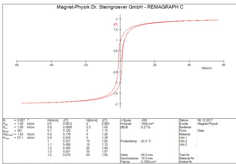
Neukurve und  $J(H)$ -Hystereseschleife einer Stabprobe, gemessen im Messjoch MJR 5. Die Ergebnis- und Informationsbereiche des Diagramms können vom Anwender konfiguriert werden.
