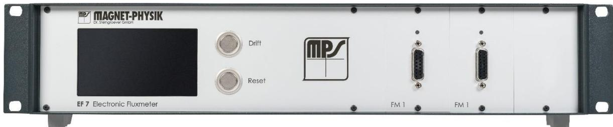
Das Elektronische Fluxmeter EF 7 dient zur Messung des magnetischen Flusses mit Messspulen. Es enthält einen, oder zwei präzise elektronische DC-Integratoren mit hoher Empfindlichkeit und äußerst niedriger Drift.
